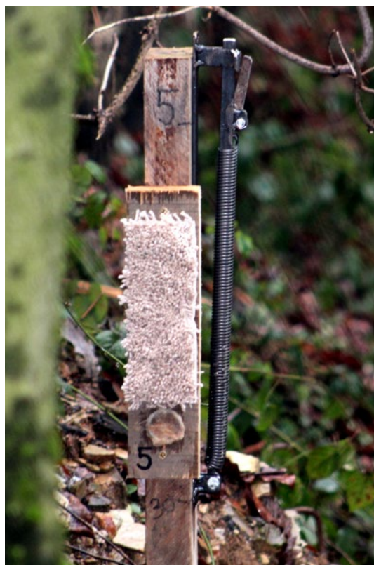
Slika 2: Druga različica vonjalne postaje z aktiviranim enojnim aktivnim vzmetnim lovilcem, pasivnim lovilcem, atraktantom, oznako lokacije v ogradi in višinsko skalo (Smolej, 2018).
