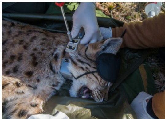
Slika 3: Telemetrična ovratnica na risu z veznim členom iz bombaža, ki ob morebitni okvari mehanizma drop-off omogoča, da ovratnica čez čas odpade z živali. Foto: Lan Hočevar
